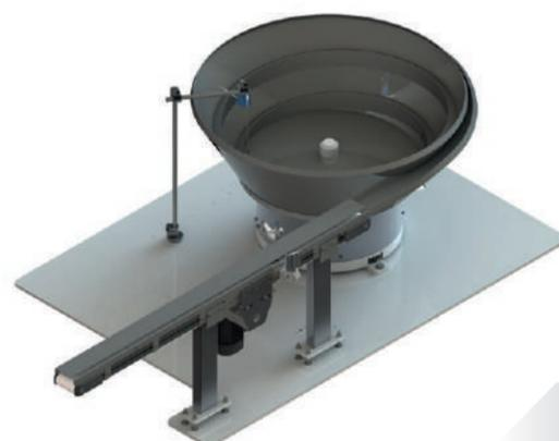
Isola di asservimento utilizzata per l'orientamento e incolonnamento non in accumulo di svariate quantità di particolari
