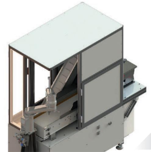
Impianto composto da un nastro vibrante per permettere la presa del robot con sistema visione ed un nastro di rientro per pezzi non orientati.
