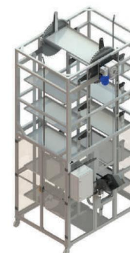
Permette lo stoccaggio di 36 scatoloni 40x60 cm a valle di un impianto di produzione. Lo smistamento è automatico
