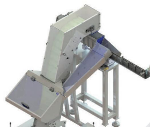
Permette la selezione e l'orientamento con un vibratore lineare. Adatto per forme facilmente orientabili e stabili.
