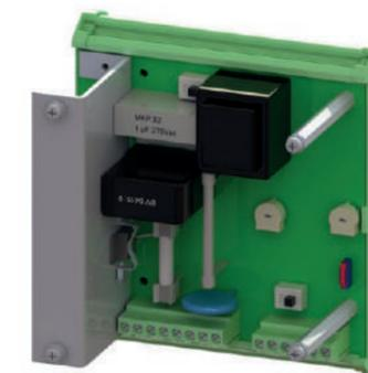
Circuito elettrico base per la gestione delle isole di asservimento con possibilità di controllo da PLC, gestione delle frequenze e delle ampiezze. Associati talvolta ad accelerometri.
